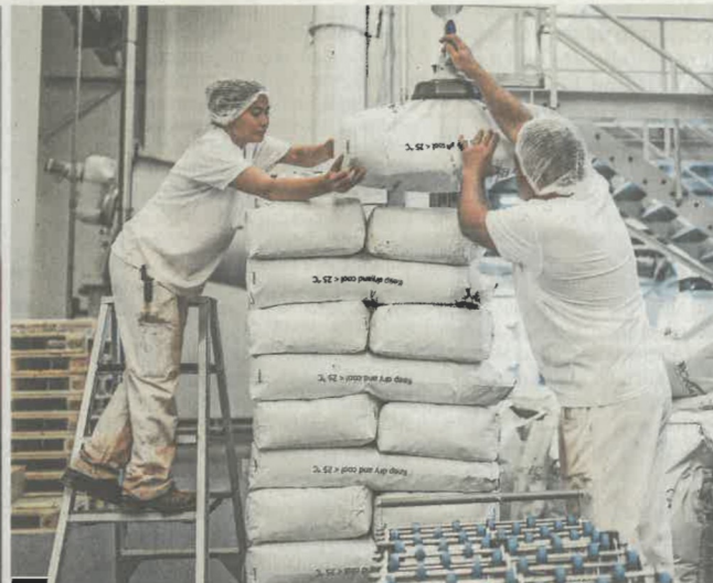
Vakuum macht's möglich: Die 25 Kilogramm schweren Säcke werden mithilfe eines Sauggeräts
