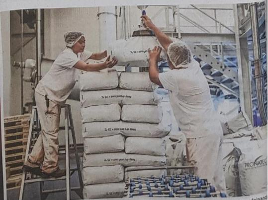
Vakuum macht's möglich: Die 25 Kilogramm schweren Säcke werden mithilfe eines Sauggeräts aufeinander
